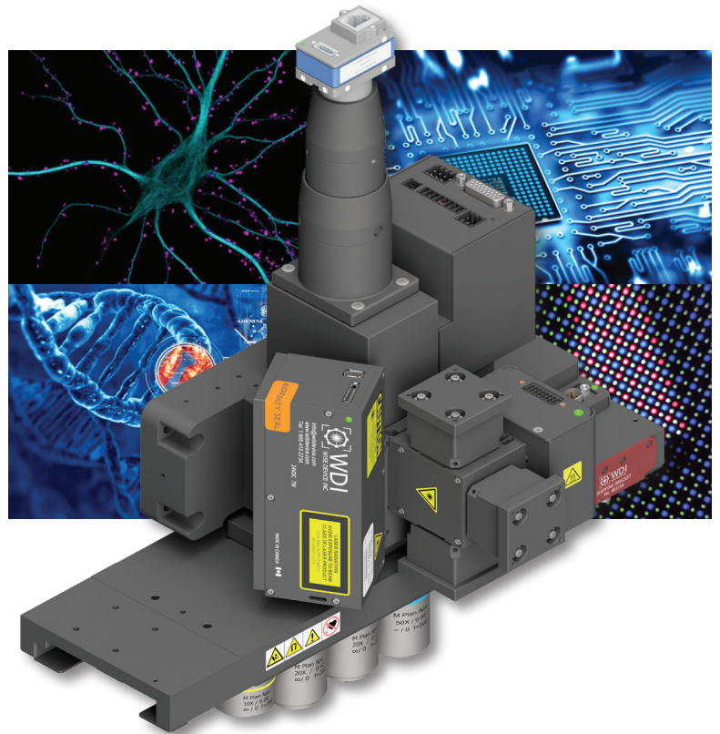
PFA-LN 센서와 MMS 솔루션은 생명과학, 반도체, 평판 디스플레이 및 머신 비전 측정과 같은 고성능 현미경 이미징 애플리케이션을 위해 설계되었습니다.
